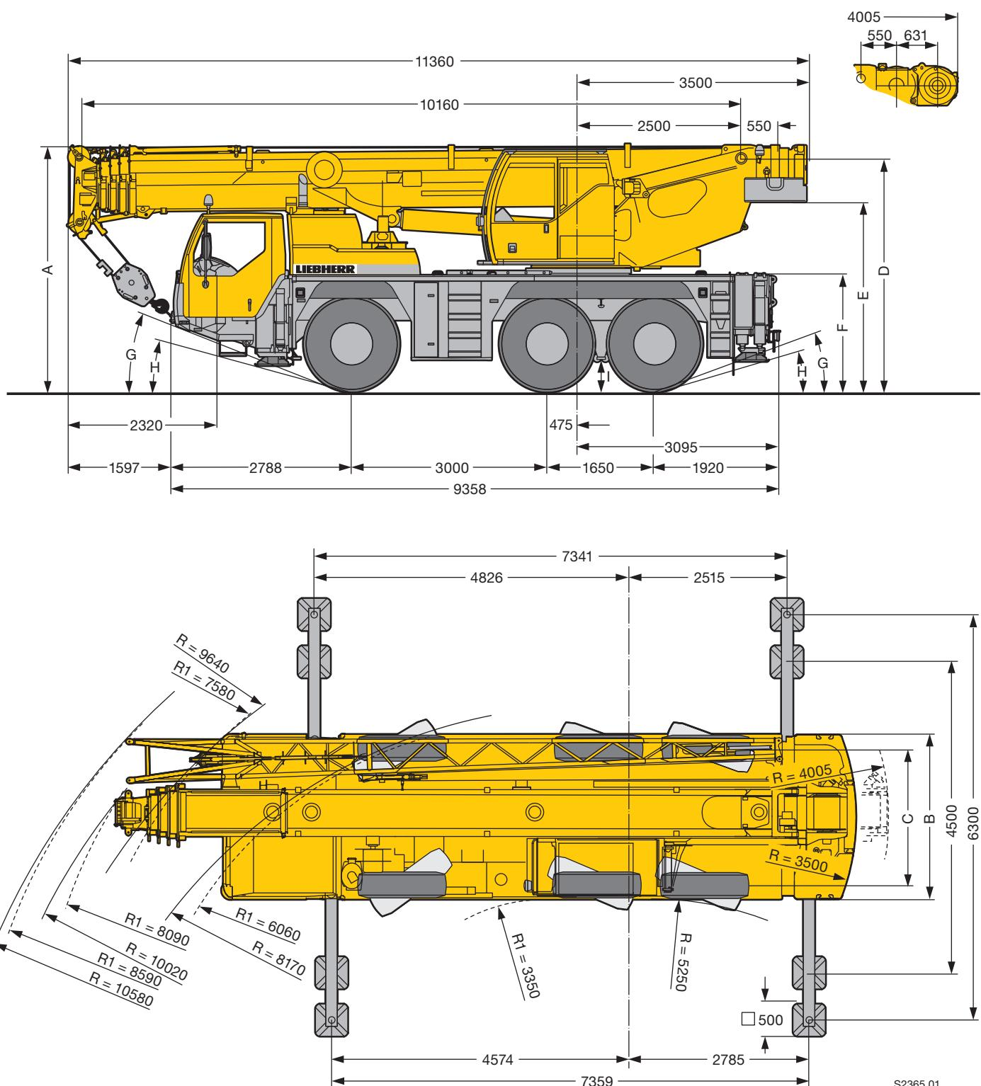
$R_1$  = Allradlenkung · All-wheel steering · Direction toutes roues · Tutti gli assi sterzanti · Dirección en todos los ejes · Поворот всеми колесами
